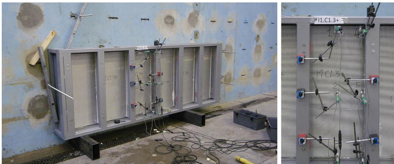
Для каждой плиты, которая подвергалась нагрузке, деформации были выявлены при помощи специального оборудования. Для получения значений устойчивости к ветровой нагрузке, пожалуйста, обращайтесь к Project Management Laminam SpA по адресу : [infobim@laminam.it](mailto:infobim@laminam.it)
